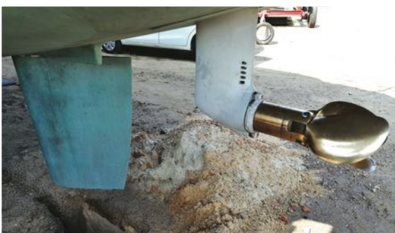
Sortie d'eau de Maitai à Richard's Bay afin de réparer un joint de saildrive et de caréner.
